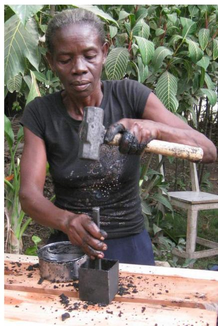
Figure 16: Using the briquette press
